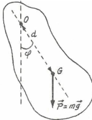
A differenza del pendolo semplice il pendolo composto è costituito da un corpo rigido libero di ruotare attorno ad un asse fisso non passante per il centro di massa. Considerando le forze agenti e trascurando ogni forma di attrito, si ottengono, come nel caso precedente, le equazioni
