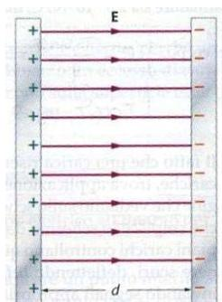
**Figura 2.** Condensatore a facce piane e parallele. In questo caso ideale il campo elettrico è uniforme fra le due armature e nullo all'esterno.
