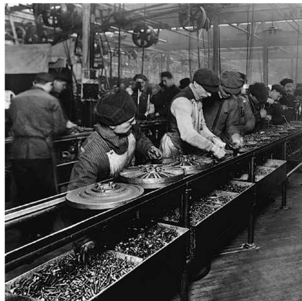
Operai della Ford Motor Company al lavoro, in una foto d'epoca. Nel 1913 l'industriale statunitense Henry Ford introdusse nel suo stabilimento il sistema della catena di montaggio per aumentare la produttività; tale sistema consiste in sostanza nell'assegnare a ogni operaio una sola fase della lavorazione.
