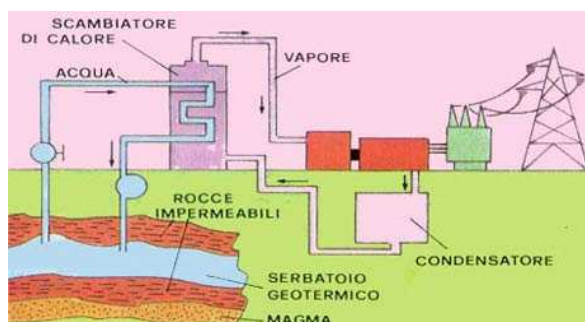
Schema di una centrale geotermica.
