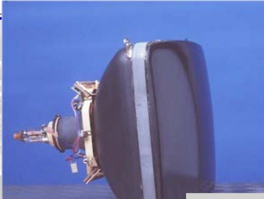
**Il tubo a raggi catodici, basato sul primo oscilloscopio, realizzato da K. F. Braun (1897)**
