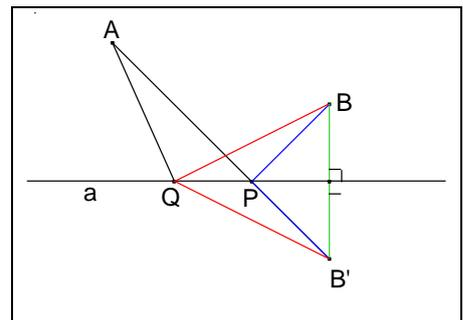
In conclusione: **il percorso minimo da  $A$  a  $B$ , dovendo toccare  $a$  è determinato dal punto  $P$  intersezione dell'asse  $a$  con il segmento  $AB'$ , con  $B'$  simmetrico di  $B$  rispetto ad  $a$ .**
