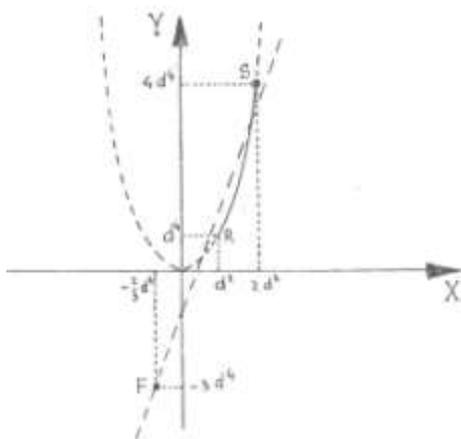
Si ha la tangenza fra retta generica del fascio e l'arco di parabola RS quando  $m^2 = 2d^2$  cioè, come si vedrà, quando la retta del fascio passa per R.
