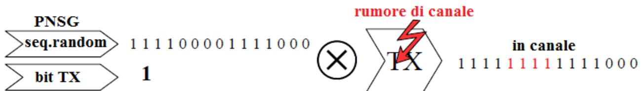
A livello di ricevitore CDMA è possibile utilizzare il registro  $R_{RX}$  sopra citato per reiettare efficacemente la BER (Bit Error Rate) che affligge la corretta ricostruzione del segnale digitale informativo  $S(t)$ :
