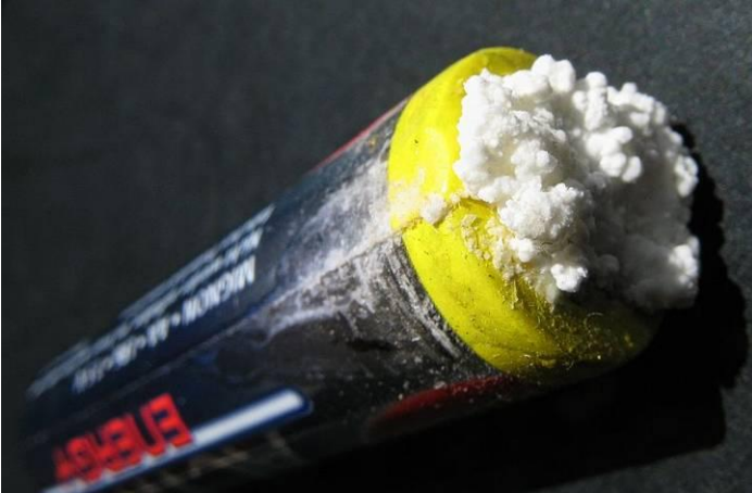
Elettrolita (idrossido di potassio) fuoriuscito da una pila alcalina danneggiata.
