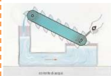
Figura 279 Dislivello di un fluido come analogia per la corrente elettrica
