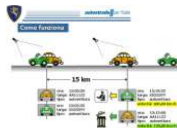
Figura 83 Sistema Tutor autostradale
