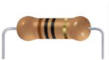
Figura 286 Esempio di Resistore con Resistenza di circa 10 \Omega
