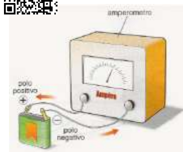
Figura 276 Intensità di corrente misurata da un Amperometro
