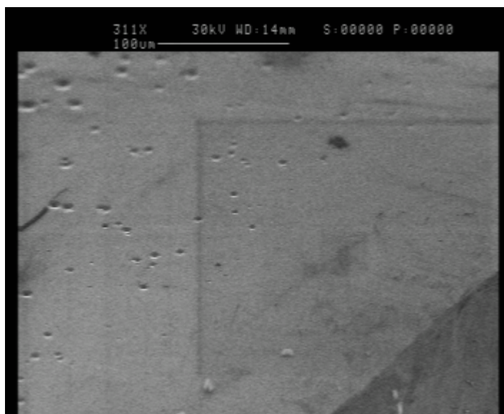
Fig. 2.10 Diamante monocristallino al microscopio ottico; non si osservano i difetti estesi costituiti dai bordi grano, ma solo impurezze puntiformi.
