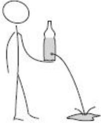
La pressione dell'acqua sovrastante, dovuta alla gravità, spinge l'acqua fuori. Inoltre la legge di Torricelli dice come la velocità del getto dipende da  $g$  e da  $h$  (altezza del liquido):  $v = \sqrt{2gh}$ . Ora si lascia cadere la bottiglia, o la si lancia a un compagno (senza farla ruotare): si constata che durante il volo l'acqua non esce
