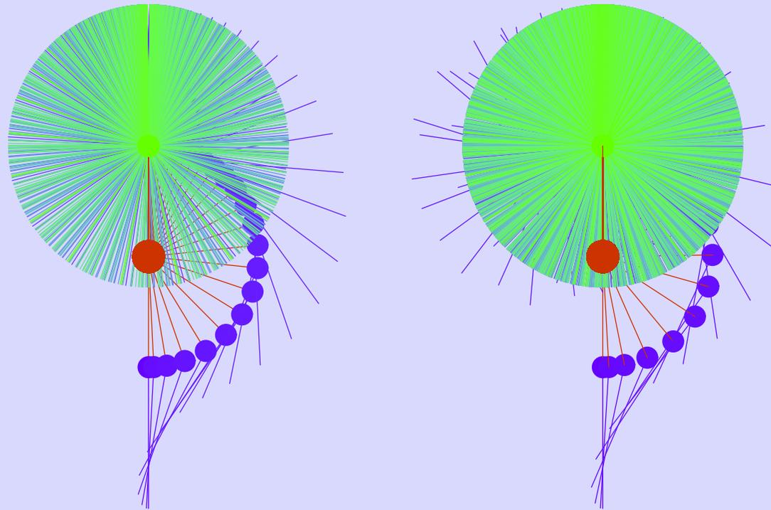
Il secondo link compie tipicamente o giri completi (fig a DX) oppure no, oscillando (fig a SX).
