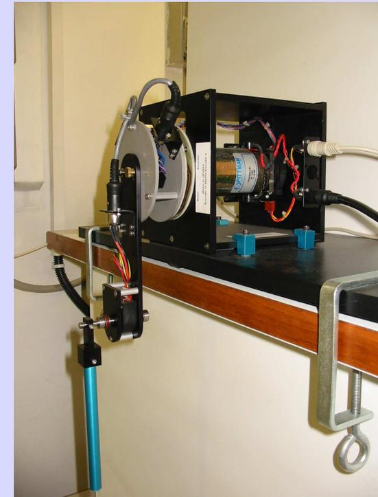
Nel seguito considereremo le costanti  $\theta_1, \dots, \theta_5$  che dipendono dai parametri del Pendubot. Lo stato sarà:  $x_1 = q_1, x_2 = q_2, x_3 = \dot{q}_1, x_4 = \dot{q}_2$ .
