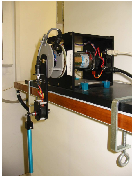
Figura 6.1: Il Pendubot presso il D.I.S. “Antonio Ruberti” dell’Università “La Sapienza” di Roma. Notare l’attuatore.
